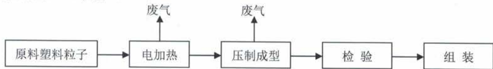
图 3-7 塑料壳体加工工艺及产污环节图
